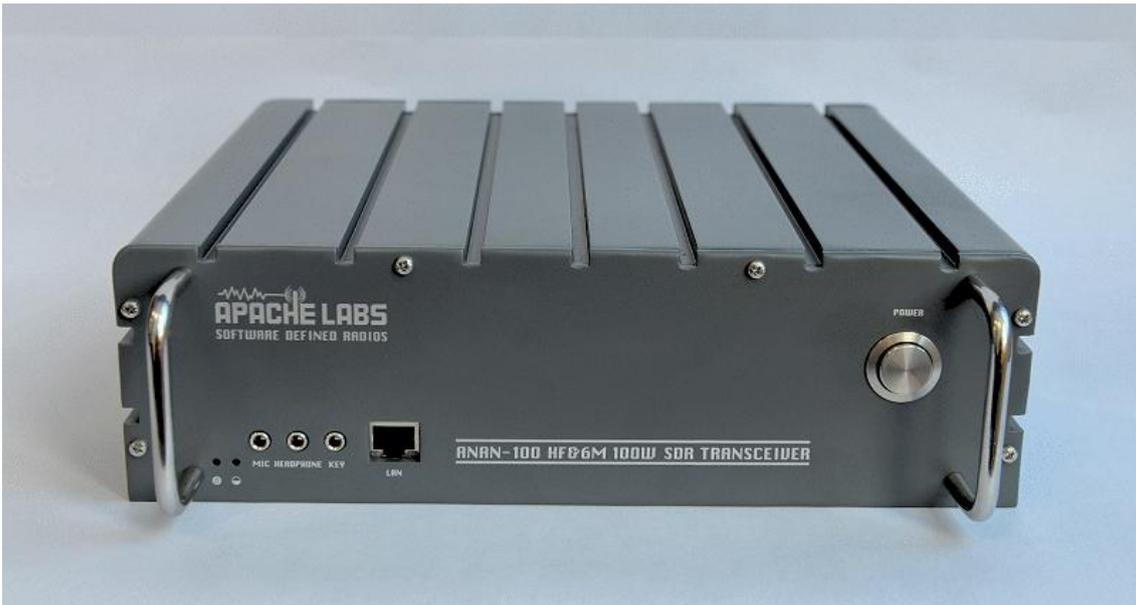
O ANAN-100 incorpora uma placa HERMES e um PA de 100W, sendo que o 100D(D de **D**iversidade) incorpora a placa ANGELIA e um amplificador de 100 W idêntico ao anterior. A caixa em alumínio extrudido é idêntica para ambos os modelos.
